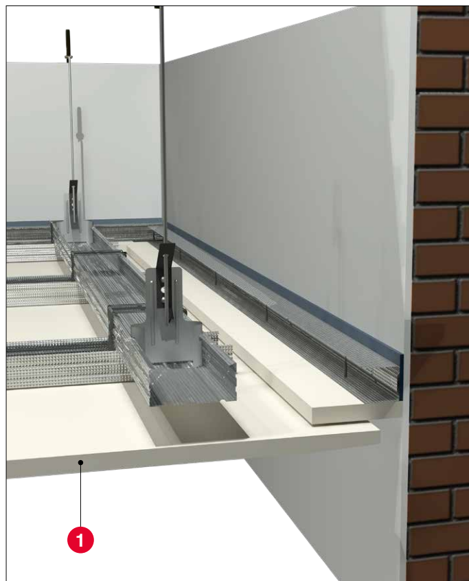
6. ábra Dilatációs kapcsolat álmennyezetekben
