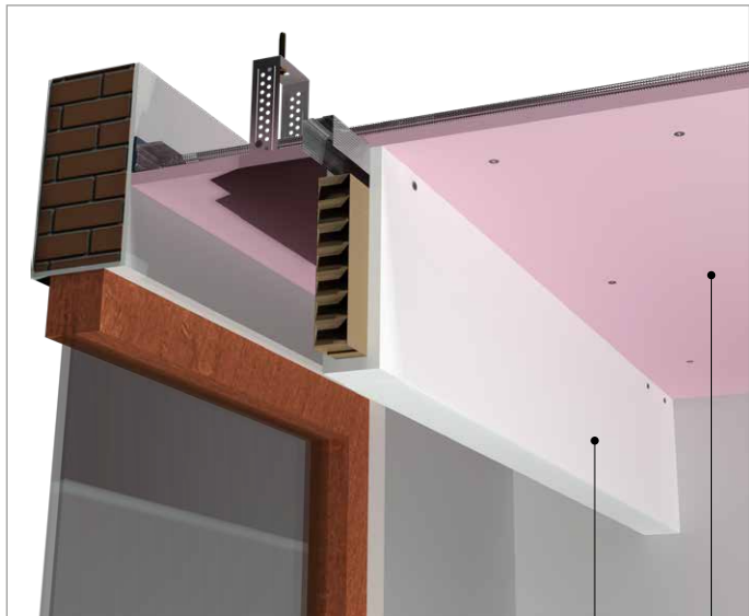
17. ábra NORGIPS karnistakáró elem rögzítése a mennyezetburkolatra
