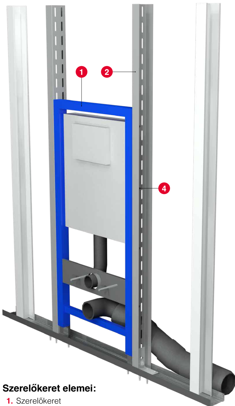
Szaniter szerelőkeretek a válaszfalban
